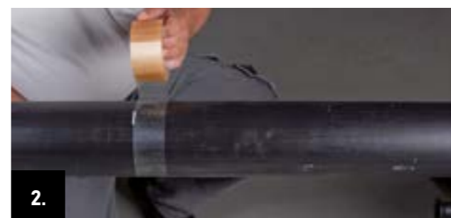
2. Позначте лінію розрізу по периметру труби скотчем.
