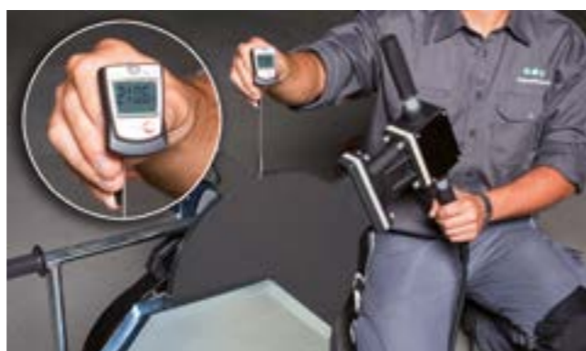
Вимірювання температури на машині стикового зварювання aquatherm
