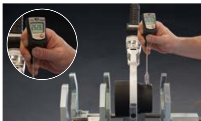
Вимірювання температури на зварювальному апараті aquatherm
