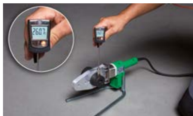
Вимірювання температури на ручному зварювальному апараті aquatherm (800 Вт)
