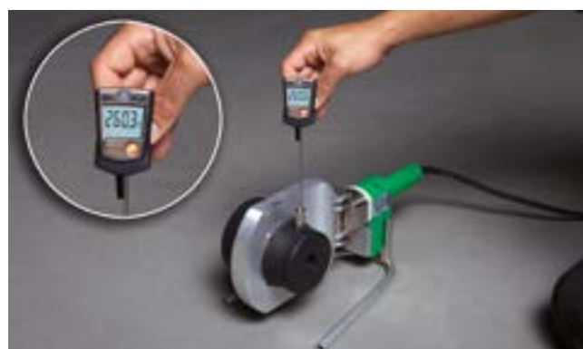
Вимірювання температури на ручному зварювальному апараті aquatherm (1400 Вт)
