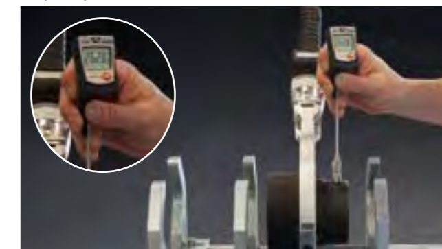
Вимірювання температури на зварювальному апараті aquatherm
