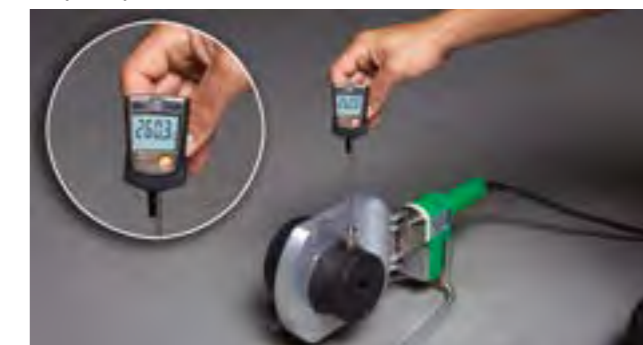
Вимірювання температури на ручному зварювальному апараті aquatherm (1400 Вт)
