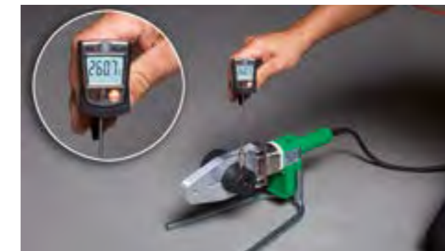
Вимірювання температури на ручному зварювальному апараті aquatherm (800 Вт)
